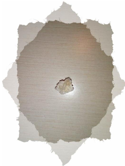
**Descrizione macroscopica:** *Malta di allettamento caratterizzata da un legante di colore biancastro / avana, media coesione, elevata addensamento di aggregato.*
